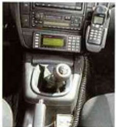
Grifflige Argumente für den Bündelfunk bietet dieser VW Passat, der als Notarztwagen dient. Das Daten-Display Datcom ist unten, darüber sind Radio und Klimaanlage. Das Handy – mit Freisprecher – steckt daneben; es wurde auf besonderen Wunsch der Ärzte eingebaut. Unter der Gangschaltung sichtbar ist das Bedienteil für das vorgeschriebene Funkgerät (4-Meter-BOS, das Kürzel steht für "abhörsicheren Behördenfunk"), welches im Handschuhfach installiert ist. Erforderlich ist es nicht, da mit Bündelfunk ebenfalls abhörsicher gesprochen werden kann.
